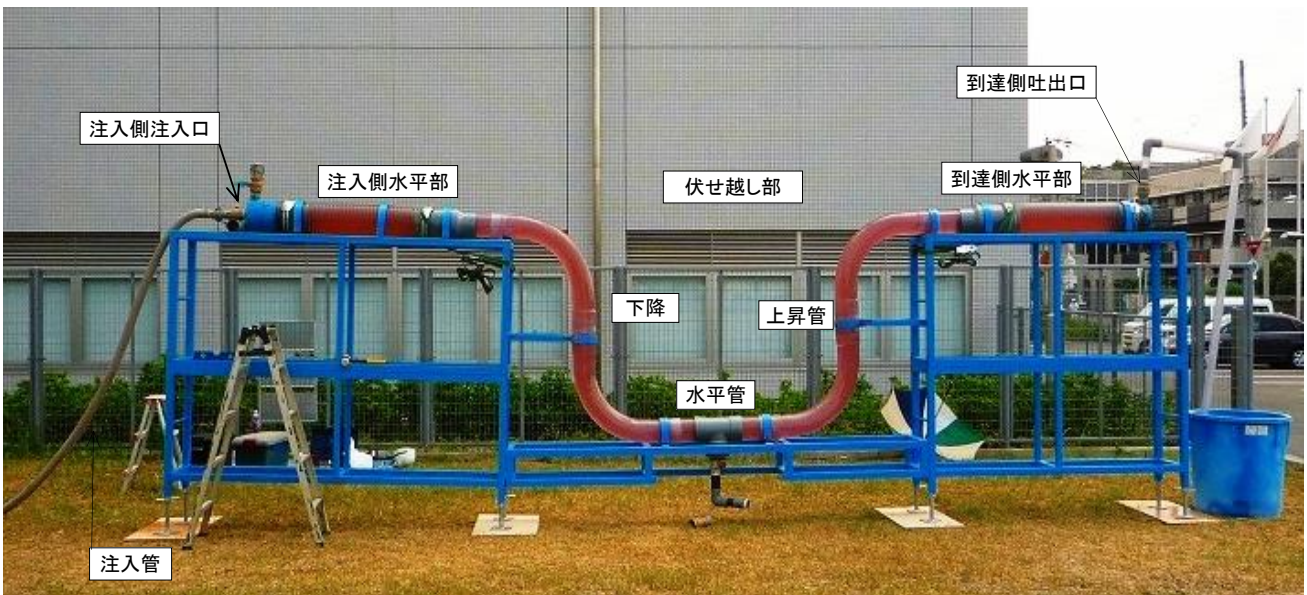
管内を満水状態とした試験装置
