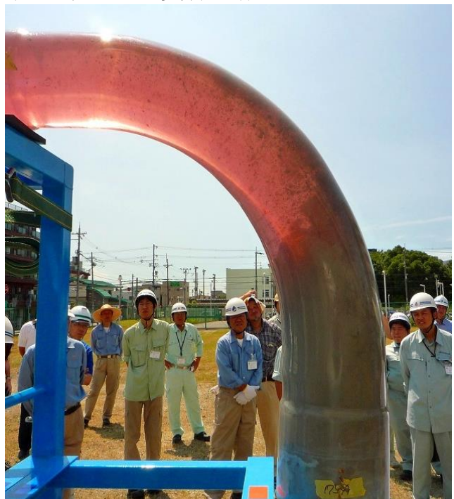
伏せ越し部上昇管進行状況：若干の遊離物の発生が見られるが境界面は保たれている
