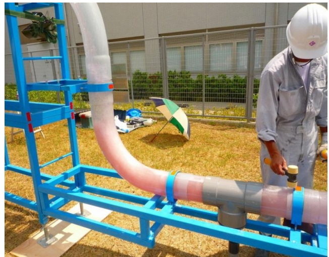
充填材の動きを確認しやすいよう滞留水は赤色に着色
