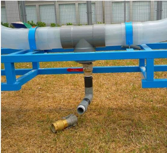
管内を満水状態とした試験装置
