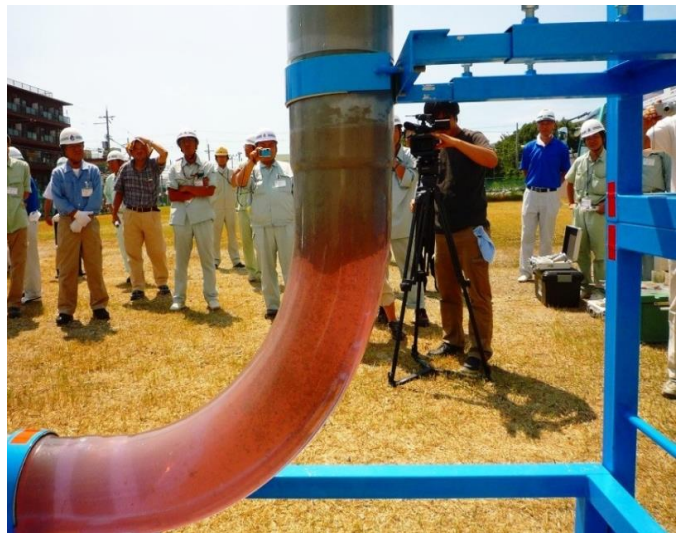
伏せ越し部下降管進行状況：若干の遊離物の浮遊が見られるが境界面を保って進行している
