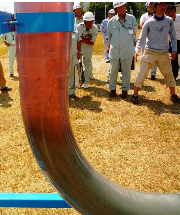
伏せ越し部上昇管進行状況：若干の遊離物の発生が見られるが境界面は保たれている
