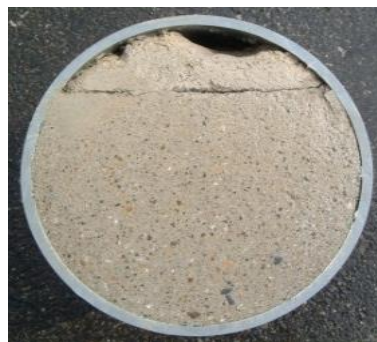
エアモルタル
